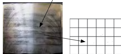
Prüfung von S Al 4020 (AlSi3Mn1) auf Porosität
